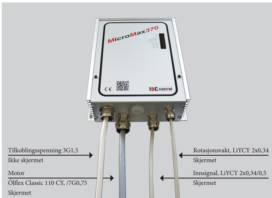
EMC-forskruing skal benyttes til skjermet kabel.
